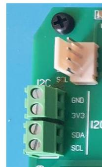
Même s'il n'est pas utilisé (application Linky ou H2O), il est conseillé de souder le connecteur 4 picots du bus I2C, toujours pratique si on veut rajouter un afficheur pour dépannage ou debug.
