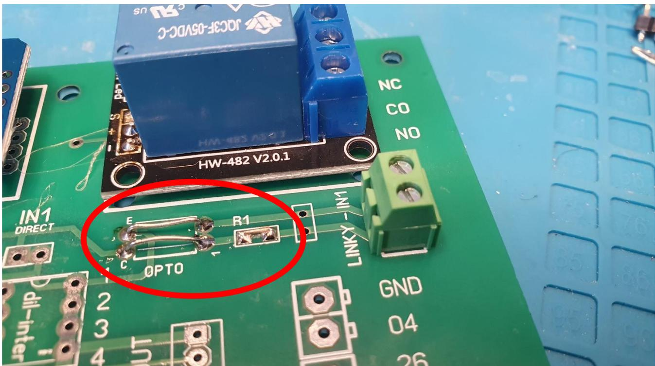
A noter qu'il peut être intéressant de remplacer R1 par une résistance de 100 Ohm.
