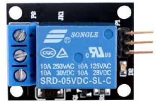
**Il est très important de souder le module relais, complètement collé au circuit imprimé, pour éviter toute torsion des 3 pattes de liaison au moment où l'on vient visser les borniers bleus du relais.**
