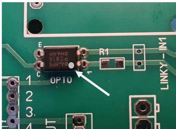
Dans le cas du montage Linky, on utilise un optocoupleur **LTV-814** (optocoupleur AC) pour démoduler le signal en provenance de la prise TIC.
