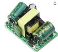
il faut préalablement souder sur le module les 4 pattes de composant pour pouvoir le souder directement sur le circuit (L,N,5V et GND).
