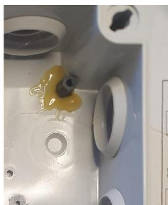
La connectique a été prévue pour un câblage par le bas (goutte d'eau) avec un boîtier à la verticale.
