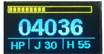
Il y a donc une application sur le MULTI32 et une autre sur l'afficheur (carte ESP8266 avec afficheur OLED 0.96).
